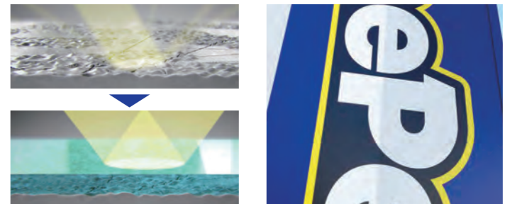
ガラス被膜が凹凸を埋め、看板表面を平滑化し、 光の乱反射を解消。
